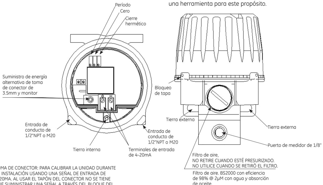
TOMA DE CONECTOR: PARA CALIBRAR LA UNIDAD DURANTE LA INSTALACIÓN USANDO UNA SEÑAL DE ENTRADA DE 4-20MA. AL USAR EL TAPÓN DEL CONECTOR NO SE TIENE QUE SUMINISTRAR UNA SEÑAL A TRAVÉS DEL BLOQUE DEL TERMINAL. LA SEÑAL DE ENTRADA PUEDE MONITOREARSE A TRAVÉS DE LA TOMA DEL TAPÓN DEL CONECTOR CUANDO LA UNIDAD ESTÁ EN OPERACIÓN.
